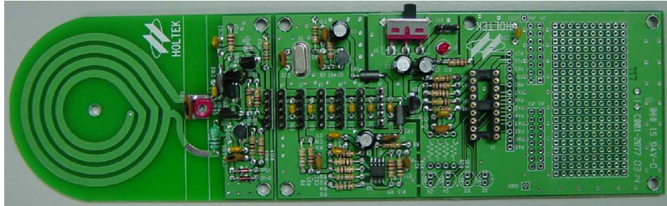
RFID 公版實作圖(2~6 個天線)
