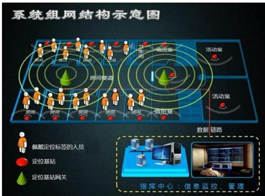
如上图所示，我们采用 RFID 半有源技术做人员区域定位管理，在每个被监控区域，如每个房间，安装半有源定位基站，也就是我们公司的低频激活器，每个低频激活器带有 4 路或者 6 路激活天线，相邻的 4 个或者 6 个房间可以共用一台低频激活器，在整个我们的定位系统中，定位基站是最小的基点，作为定位点的最近本的基点，其激活标签的距离在 3-3.5 米，也就是每个标签在激活器 3-3.5 米的范围里被激活，其定位精度可以描述为 3-3.5 米。不同区域的激活器，都有自己唯一的地址码，当人员带着半有源低频激活标签进入定位基站被激活后，标签正常工作，向外界发送标签的 ID 号，同时也发送出激活标签的激活器的地址码，这样，通过激活器的地址码，我们就能够定位出标签所在的位置。当标签从一个激活器拿到另一个位置时，上传上来的激活器地址码也会随之变化，这样，就形成了完整的定位体系。而标签上传的数据，被大范围内的定位基站网关接收到，将信息上传至管理中心进行处理，完成了整个定位系统。
