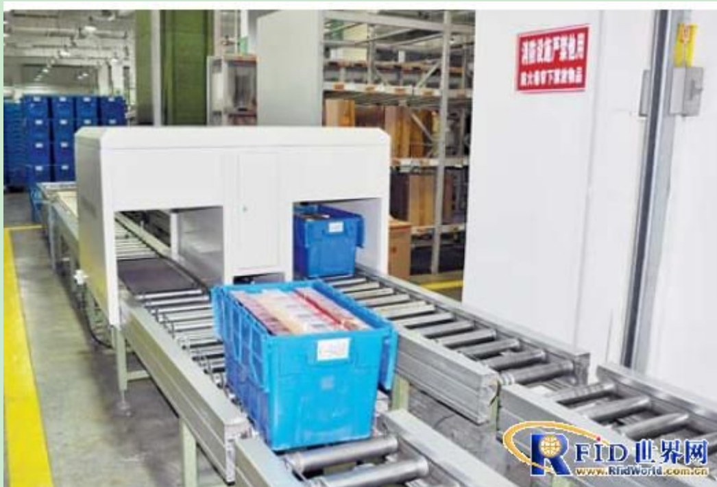
正在运行的 RFID 周转箱在线动态读写分拣线
