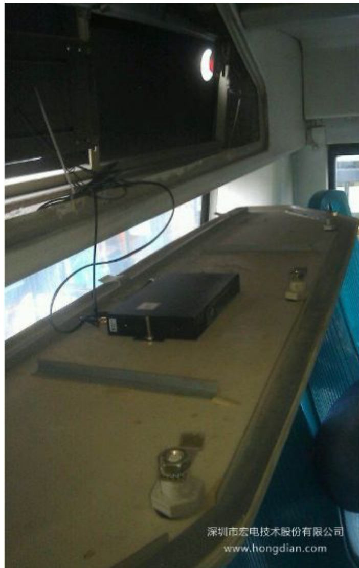
蚌埠公交上宏电移动多媒体 3G 转 Wi-Fi 车载设备
