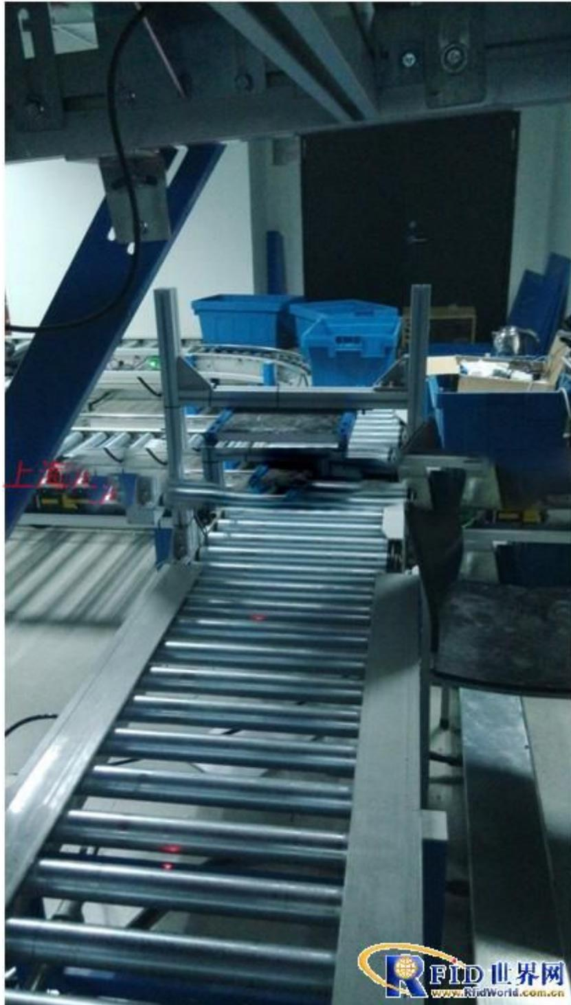
图中标注地方为图书分拣系统中多本书籍的识别，目的是对图书分拣过程监控，目前采用上海营信 YX9291TDB 读卡器十五套。
