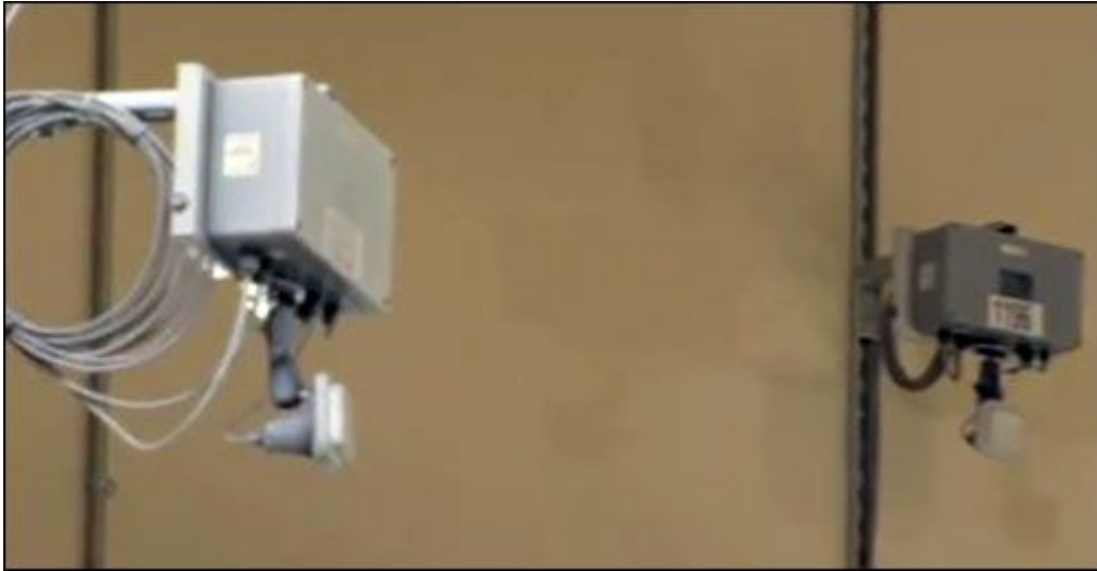
航空公司在飞机机库安装的斑马 MotionWorks UWB 接收机。
