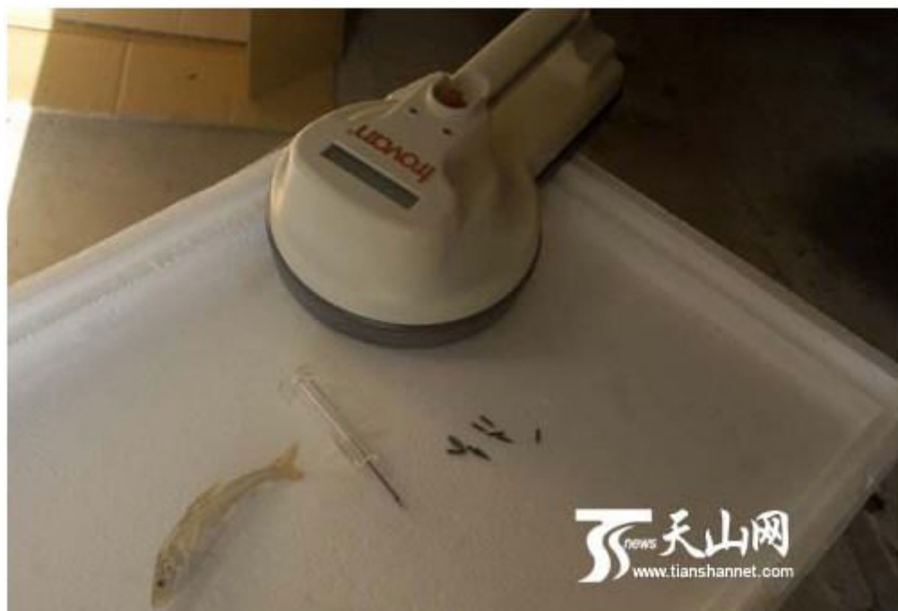
无线射频电子标签（小）和探测仪、注射器
