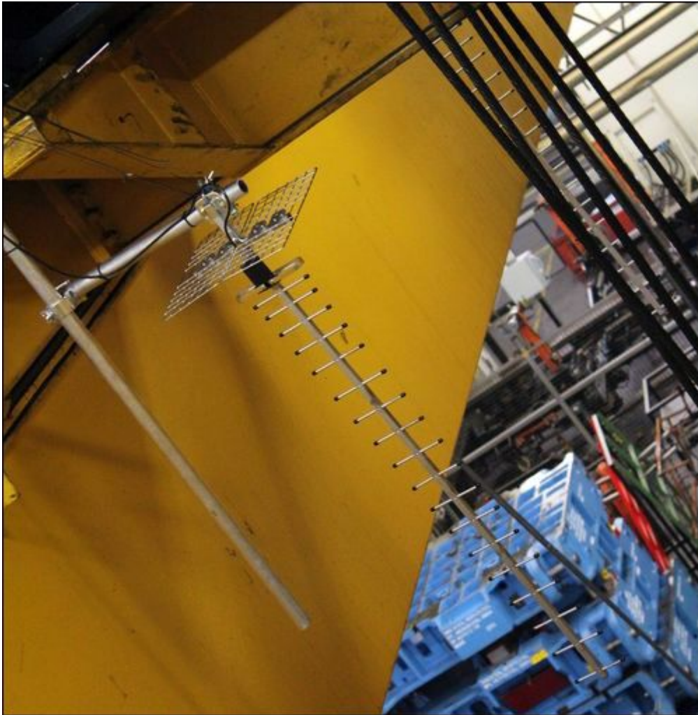
(起重机使用了定制的RFID 读取器天线，可在 15 米范围内读取工具及位置标签)
