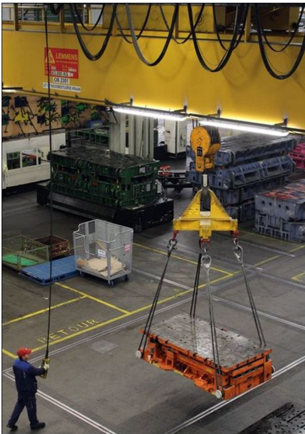
(Voestalpine Polynorm 使用塔顶起重机移动重型冲压工具)
