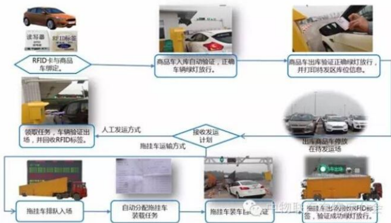
图2：长安福特整车 RFID 仓储系统运行示意图
