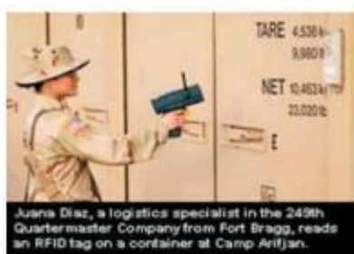
图 3 美军在由物资集结点往前线运送补给的过程中，沿线设置了移动式射频识别读取装置
