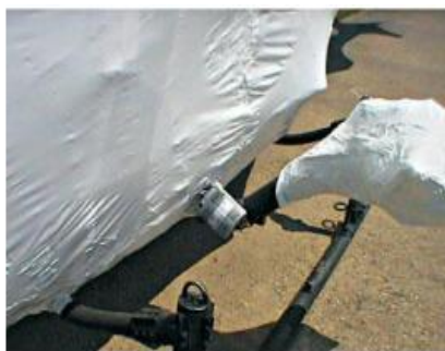
图 5 直升机上安装的射频识别标签
