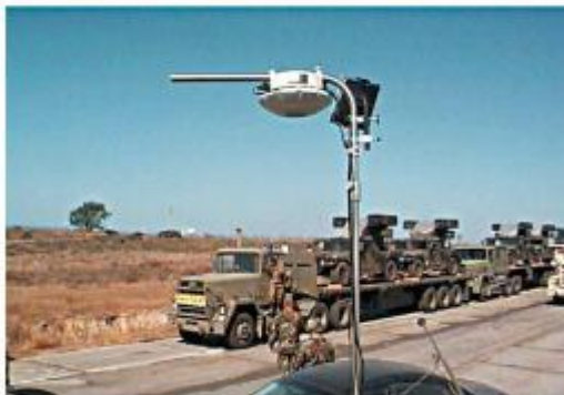
图 3 美军在由物资集结点往前线运送补给的过程中，沿线设置了移动式射频识别读取装置
